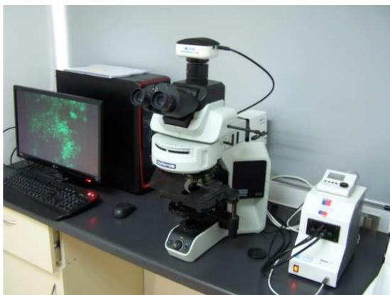
→ **Microscopio de epifluorescencia** como **cámara digital** para la observación de los especímenes y la adquisición de imágenes y PC para almacenamiento de la información
