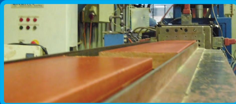
Extrusora para la obtención de perfiles, Labtech Engineering, modelo LTE26 – 40.
