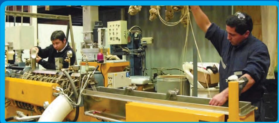
Extrusora para la obtención de pellets, Labtech Engineering, modelo LTE26 – 40. Compuesta por un equipo extrusor doble tornillo de 26 mm. de diámetro y 40L/D.
