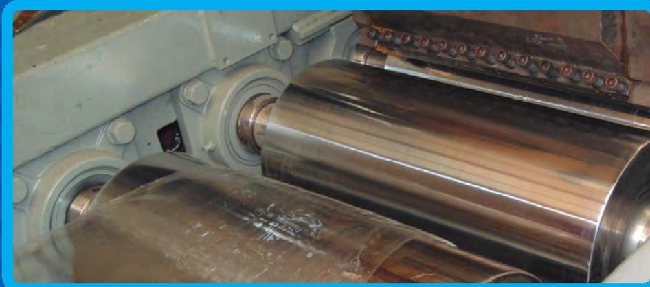
Extrusora para la obtención de lámina plana, Labtech Engineering, modelo LTE26 – 40.
