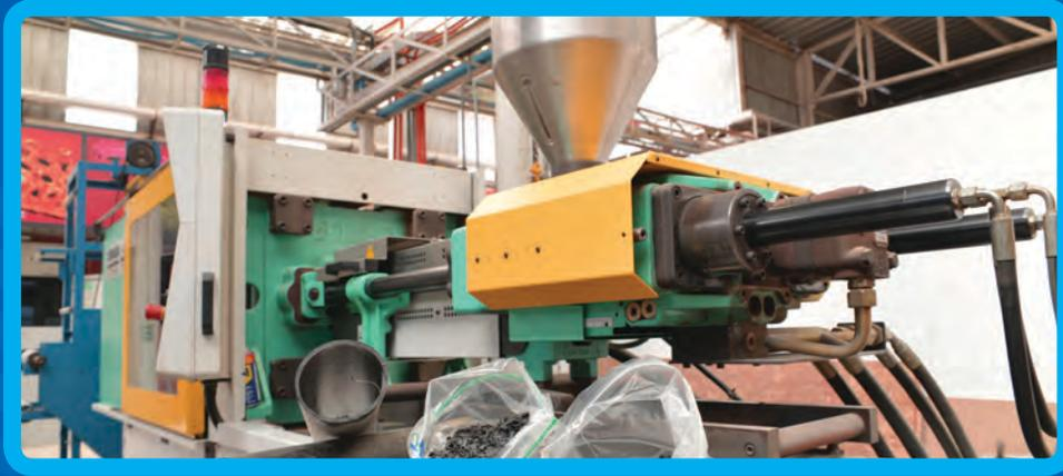
Inyectora de materiales termoplásticos, marca Arburg, modelo 420 C.
